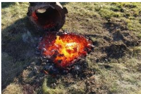
Illustrasjon 11; Ovnen er veltet, luppen tegner seg som gulhvitmasse i slagget. Foto Sten Dahle.
