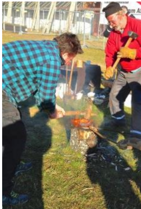
Illustrasjon 15; Luppen komprimeres med tunge slag av slegge. Fra vestre Stein Dahle og Tom Haraldsen. Foto Ellen Anne-Pedersen.
