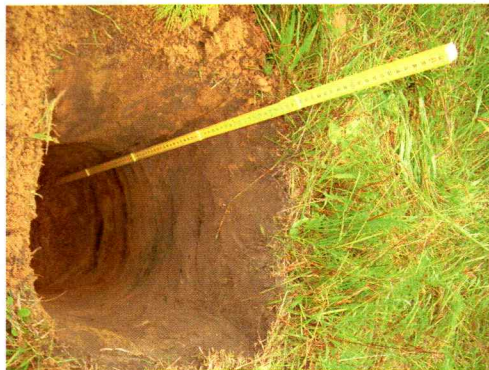
Bilde 4. Prøvestikk 8. Slamlag over undergrunnen med to mindre kullhorisonter.
